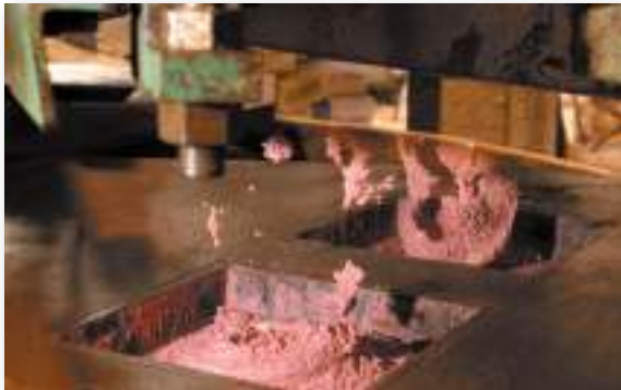
1. Versamento dell'impasto/Batch out mixture
