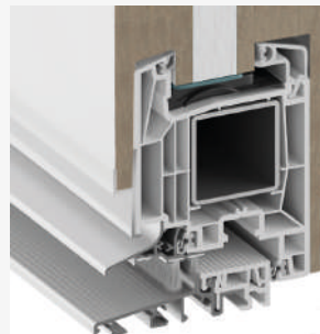
Soglia Termica ribassata completa di gocciolatoio e spazzolini, utilizzata di serie sul lato inferiore di KlimaBlind, a garanzia, rispetto ad un portone blindato standard, di una maggiore tenuta all'aria ed all'acqua, evitando inutili dispendi energetici.
