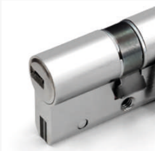
Cilindro antieffrazione con elevata resistenza al Picking. Protezione certificata a rottura ed estrazione ed al trapano grazie al sistema di cifratura in acciaio cementato.
