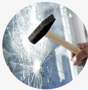
Vetri resistenti all'effrazione secondo UNI EN 356 classe P5A
